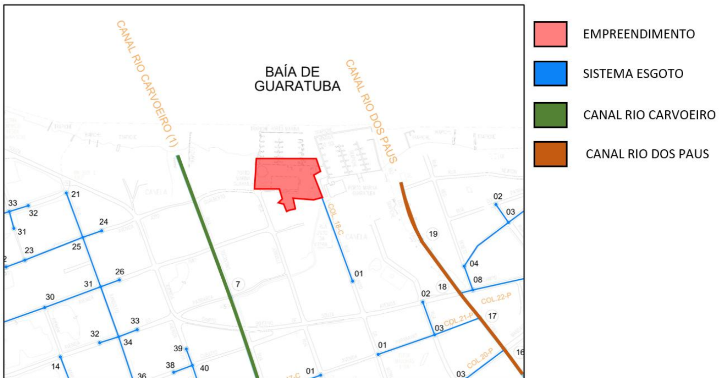
Figura 19 – Sistema de esgoto em Guaratuba. Fonte: Prefeitura Municipal de Guaratuba, editado por SYDOR arquitetura, 2024.
