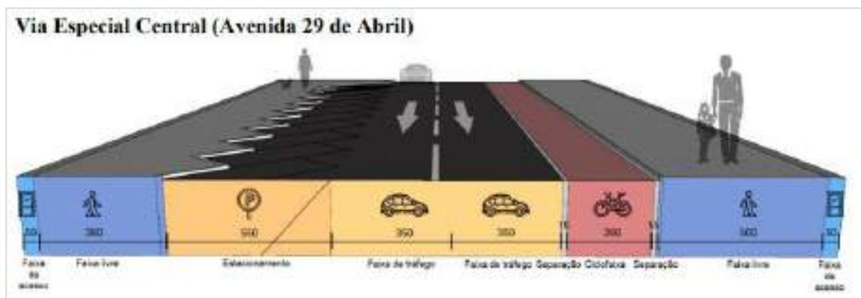
Figura 52: Figura esquemática de uma via especial central (Av. 29 de Abril). Fonte: Lei Complementar nº 018 de 25 de outubro de 2023 – Anexo IV.
