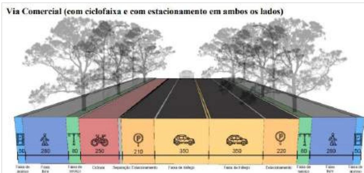
Figura 53: Figura esquemática de uma via comercial. Fonte: Lei Complementar nº 018 de 25 de outubro de 2023 – Anexo IV.
