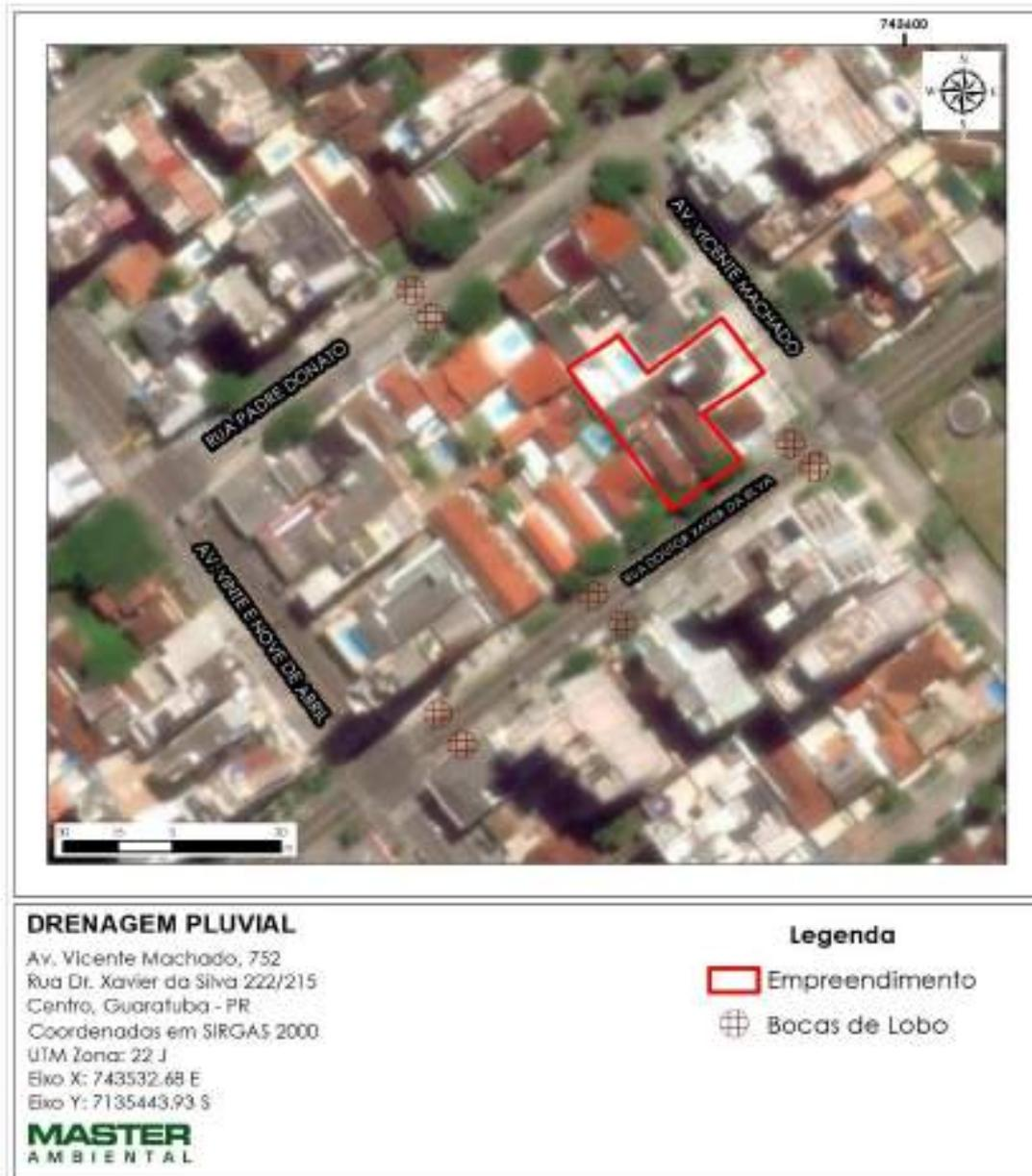
Figura 30: Drenagem pluvial. Fonte: Master Ambiental, 2024.
