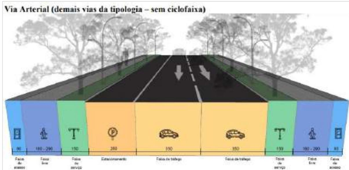
Figura 51: Figura esquemática de uma via arterial. Fonte: Lei Complementar nº 018 de 25 de outubro de 2023 – Anexo IV.
