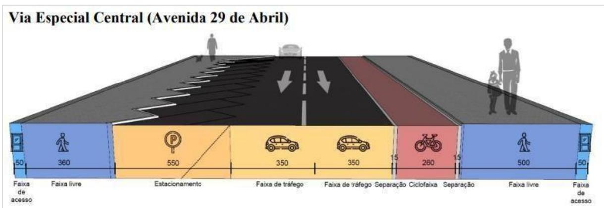
**Figura 51: Figura esquemática de uma via especial central (Av. 29 de Abril). Fonte: Lei Complementar nº 018 de 25 de outubro de 2023 – Anexo IV.**
