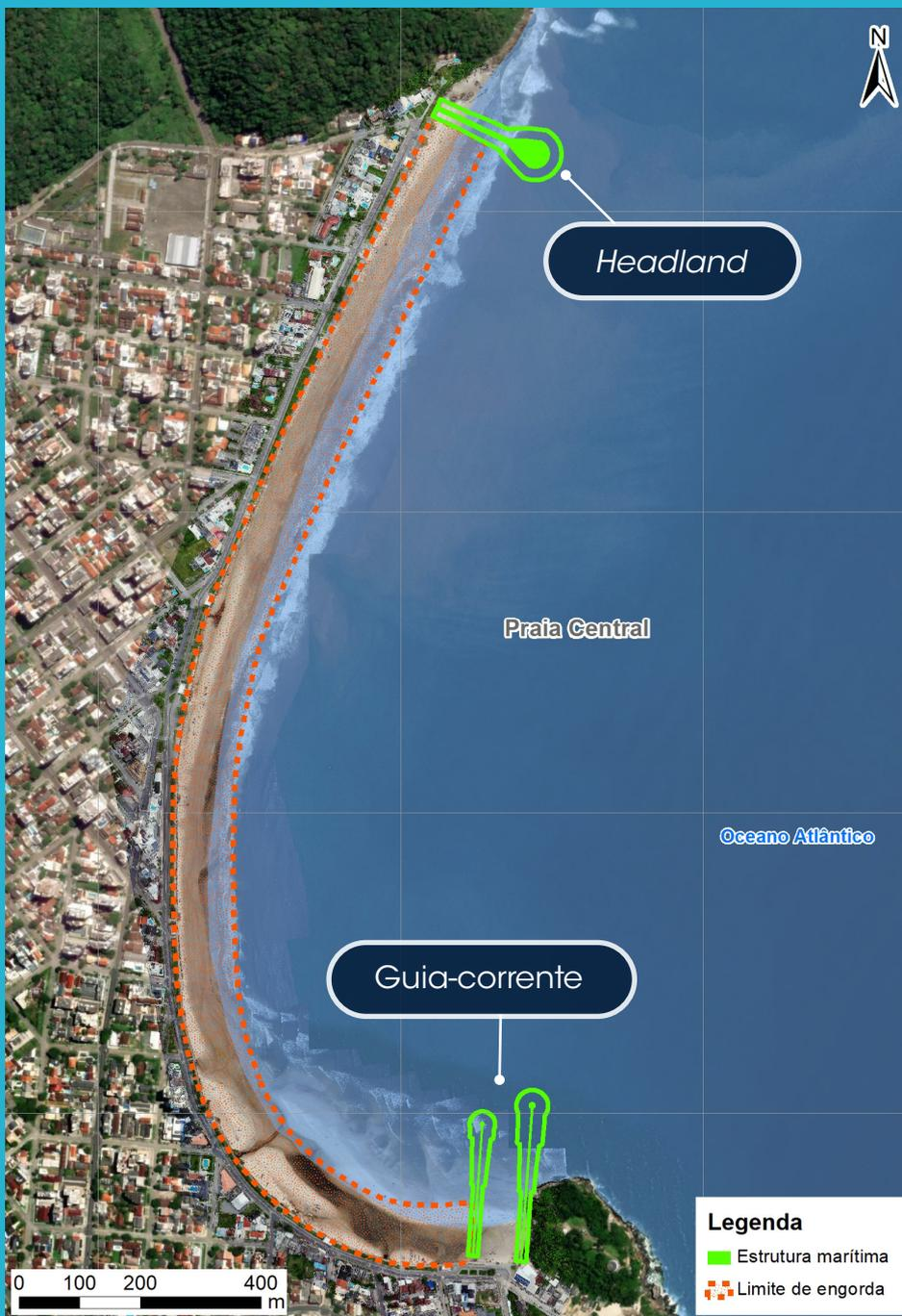
Na Orla da Praia Central, foram propostas duas estruturas marítimas: um *headland* no ponto mais ao norte; e um guia-corrente ao sul, nas adjacências do Morro do Cristo, formando um canal com aproximadamente 70 metros de largura para lançamento e diluição da drenagem pluvial e fluvial.
